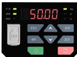
Рис. 4-3. Режим отображения параметров работы (отображение рабочей частоты – 50,00 Гц)
