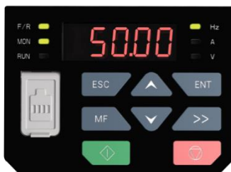
Рис. 4-2. Режим отображения параметров останова (отображение заданной частоты – 50,00 Гц)
