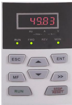
Рис. 4-6. Режим установки значения параметра (для b0-02 установлено 49,83 Гц)
