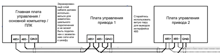
Рис. 3-32. Схема подключения интерфейса RS485
